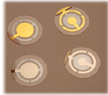
Şekil 1: QCM tabanlı 5 MHz frekanslı sensörler
