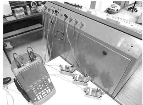
Şekil 5: AA kıyıcı ile rezistif yük deney düzeneği
