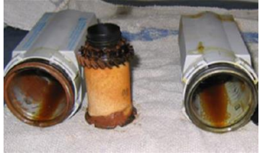
Ařırı nem sonucu tıkanmıř filtreler
