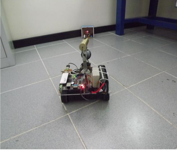
Şekil 6: Mobil Robotun Şüpheli Pakete Müdahalesi
