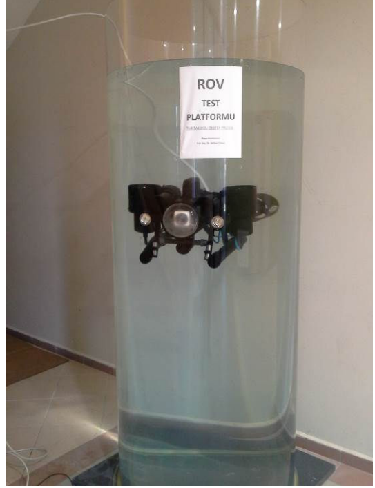
Şekil 11: Derinlik Kontrolü Uygulaması
