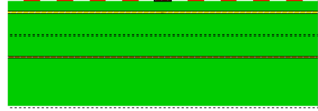
Şekil 8. Birbirine kupaşlanmış mikro şerit hat ortamında bulunan yolların kesitsel görüntüsü.
