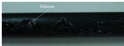
Şekil 6. Test örneklerinin deney sonrası görünümü
