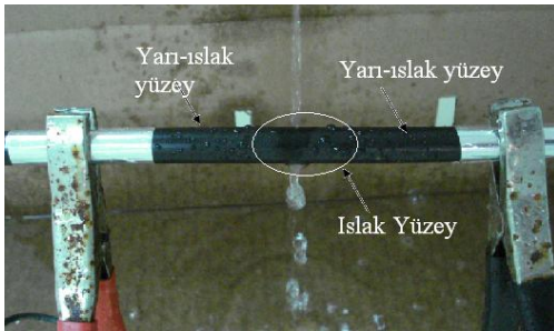
Şekil 2. Test örneği üzerinde bir yağmurlama kanalı ile ıslak yüzey oluşturulması
