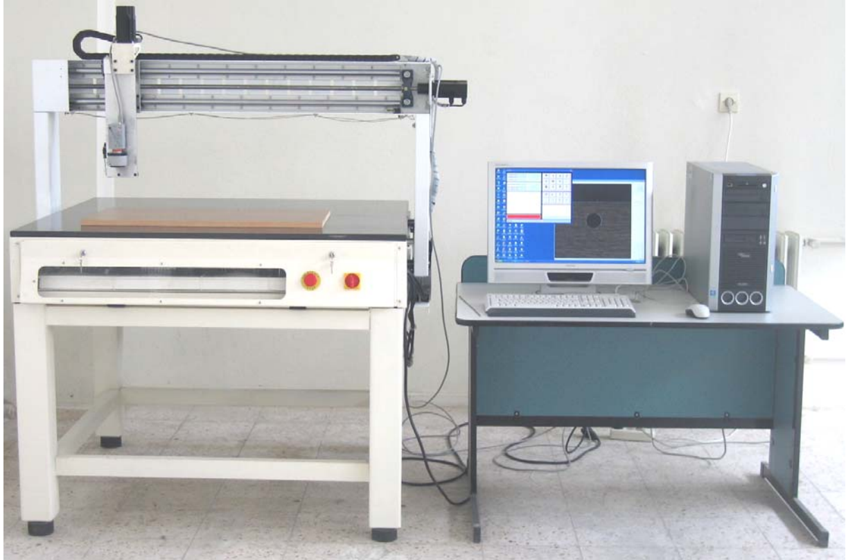
Şekil-4. Gerçekleştirilen CMOS kameralı görsel iki boyutlu ölçme sisteminin genel görünüşü.
