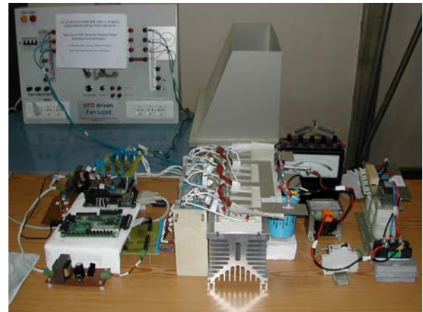
Şekil 9 Deneysel üç-düzeyle evirici sistemi ve havalandırıcı yük sistemi.
