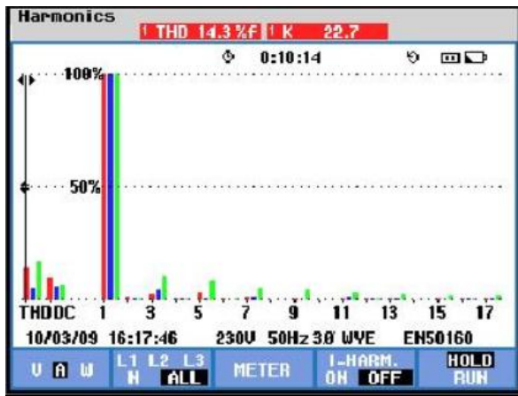
Şekil 2.1: Cıva buharlı lambaların sebep olduğu harmonik akımları
