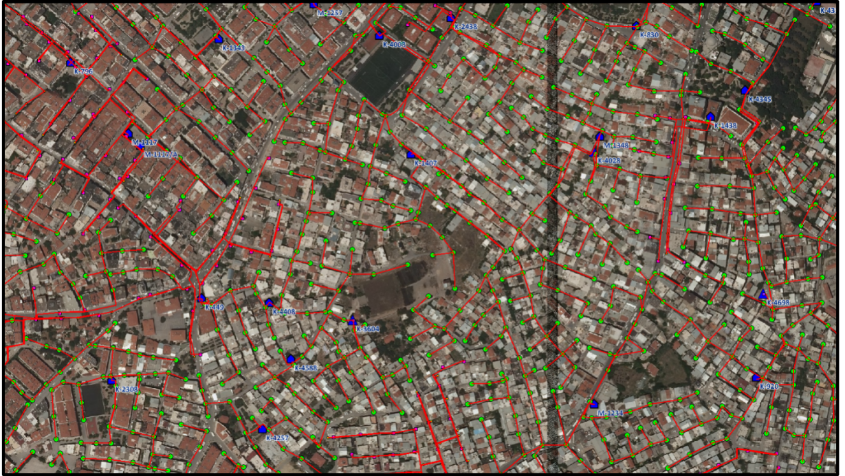
Şekil-12 AG Dağıtım Şebekesinin Ortofoto üzerinde görünümü.
