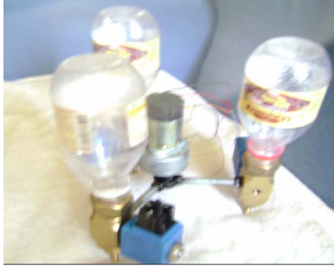
Şekil 7 :Dolum sisteminin temelini oluşturan üçlü valf sistemi
