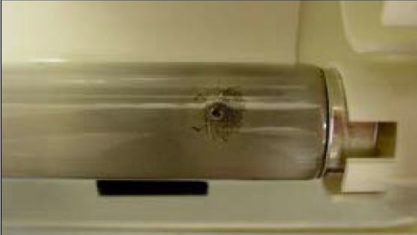
Resim 7.64-b: (EOL) Ömür sonu etkisi ile delinen bir floresan tup örneđi
