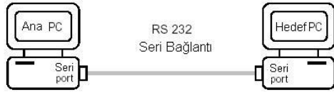
a) RS232 ile seri bağlantı
