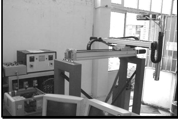
Şekil 1. Üç Serbestlik dereceli kartezyen robot kolu
