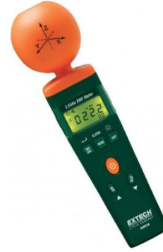
Şekil 1: Elektrik alan şiddeti ölçümlerinde kullanılan EXTECH 480836 Elektromanyetik Alan Ölçüm cihazının görüntüsü.
