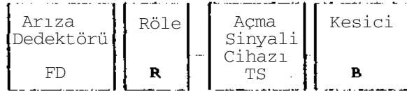
Şekil-1. Genel Bir Koruma Sisteminin Blok Diyagramı
