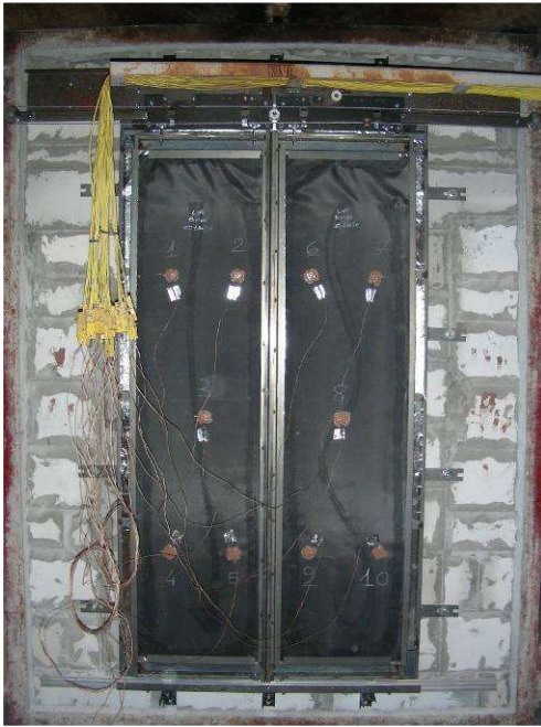
Resim 1 - Thermocoupleların kapı üzerine yerleştirilmesi
