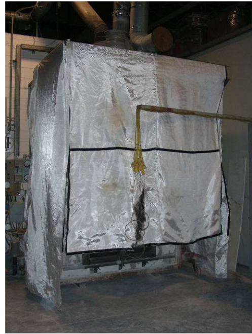
Resim 2 - TS EN 81-58 e göre kapıdan 1 m uzakta oluşturulan odacık ve oradan yapılan ölçümler
