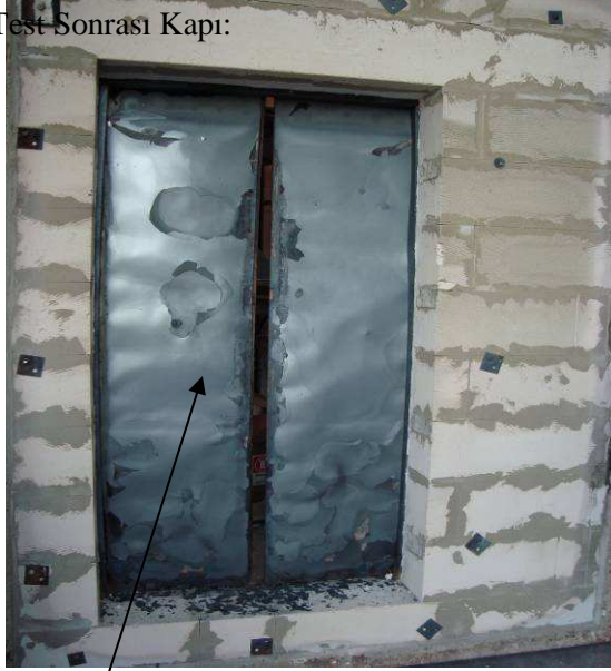
Resim 6 - Kapının test sonrası alev gören yüzü
