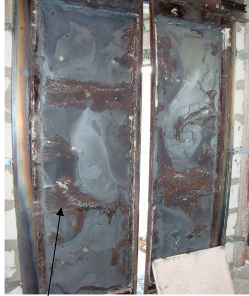
Resim 7 - Kapının Test sonrası izolasyon panelleri çıkartılmış alev görmeyen yüzü
