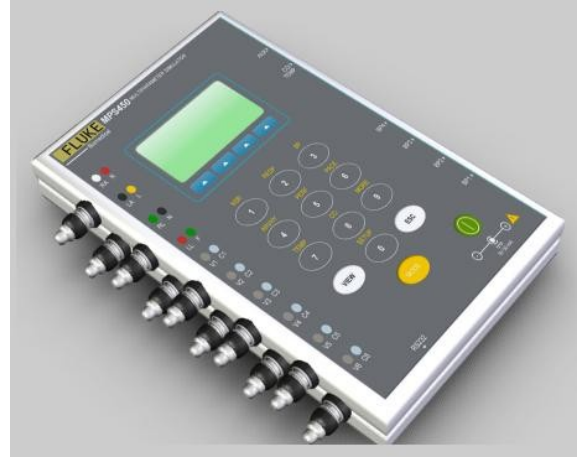
Şekil 4. Üç Boyutlu EKG Similatörü Modeli
