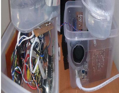
Resim 7: Ultrasonik Nebulizatör iç ve arka görünüş
