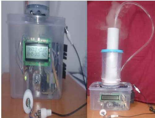
Resim 8: Ultrasonik Nebulizatör prototip görünüşü ve çalışması
