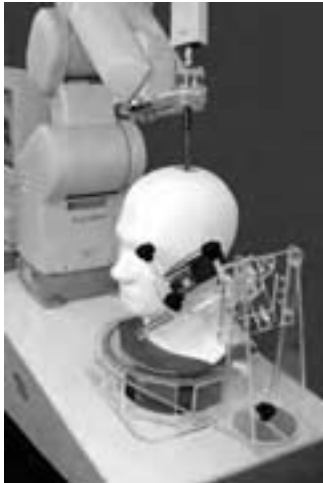
Şekil 4: TÜBİTAK UME SAR ölçme düzeneği.
