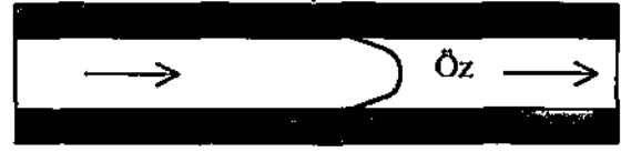
Şekil 2. Çok modlu plastik yelekli silika (PCS) fiberle sönen alan soğurmalı sensörün prensip şeması
