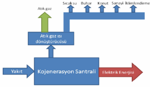
Şekil 1. Temel kojenerasyon sisteminde ısı enerji dağılımı (Anonim 2).
