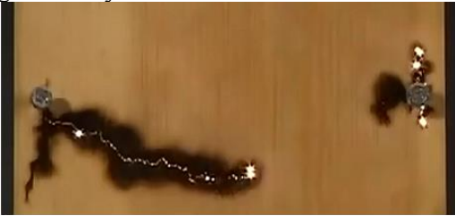
Şekil 6: İzolasyon testlerinde kullanılan ark
