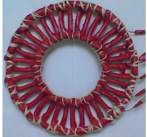
Şekil 6: Dağıtılmış faz sargılı stator yapısı
