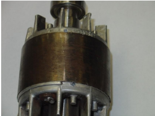
Şekil-3. Tek kırık rotor çubuğu
