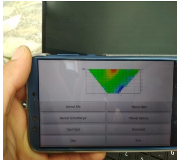
Şekil 22: Deney sahasının Wenner Alfa dizilimi seçilerek dizilimi toprak yüzeyin haritalandırılması
