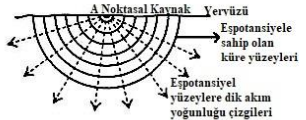
Şekil 2: Akım yoğunluğunun homojen bir toprakta dağılımı [20]
