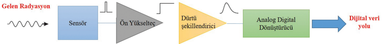
Şekil 1. Temel dedeksiyonun çalışma prensibi
