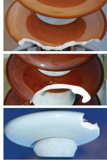
Şekil 1: Hava koşulları veya kuş gagalaması nedeniyle kırılmış izolatör diskleri [1].
