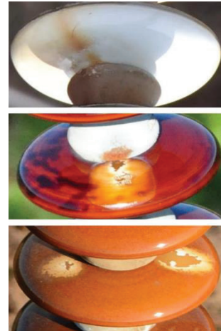
Şekil 2: Elektrik arkı sebebiyle yanmış izolatör diskleri [1].
