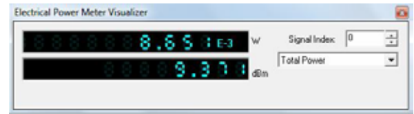
Şekil 15: Fotodetektör PIN’in çıkışındaki elektriksel sinyalin gücü.
