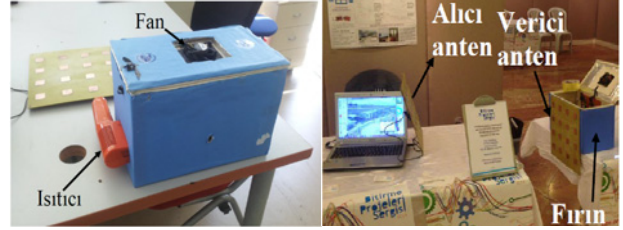
Şekil-11 Fırın otomasyonu (solda) ve genel sistem (sağda).
