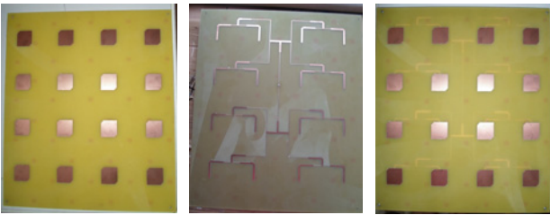
Şekil-7 Üretilen anten dizisi (en solda), güç bölücü (ortada) ve birleştirilmiş halleri (en sağda)
