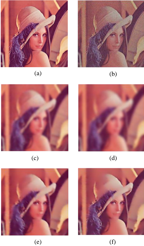
Şekil 1: Lenna test imgesindeki gürültü azaltma sonuçları: (a) Girdi imgesi, (b) gürültülü imge, (c) ısı denklemi yaklaşımı (süzgeçleme) (d) ısı denklemi yaklaşımı (sonlu farklar) (e) iz tabanlı yaklaşım (süzgeçleme) ve (f) iz tabanlı yaklaşım (sonlu farklar).
