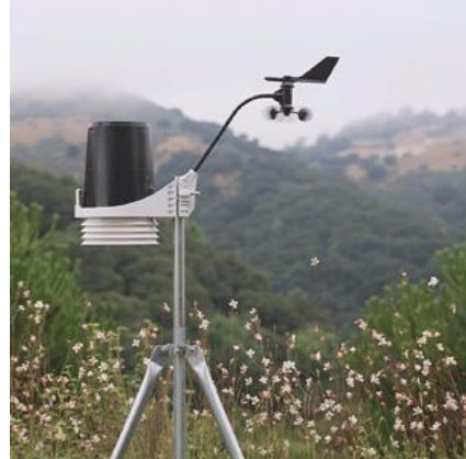
Resim 1: 6152 Davis Vantage Pro2 kablosuz hava rüzgar ölçüm istasyonunun dış ünitesi
