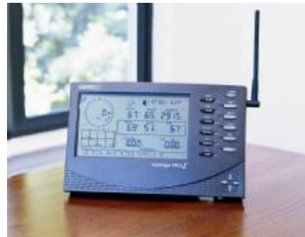
Resim 2: Rüzgar ölçüm istasyonunun parametrelerini monitör eden ve verileri toplayan iç ünite
