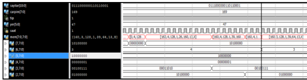
Şekil 9: r5 kaydedicisine gelen hatanın davranışsal simülasyonu
