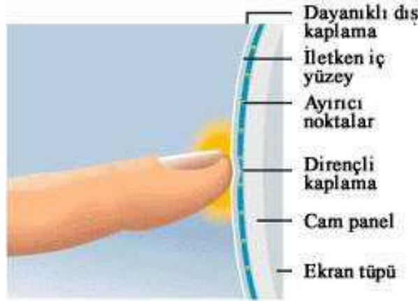
Őekil 2.1 Rezistif Dokunmatik Panel Yapısı
