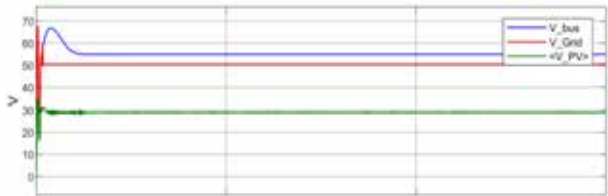
Şekil 27: 1000W/m 2 ve 0,5 yük durumunda sistem gerilimleri
