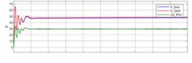
Şekil 23: 500W/m 2 ve tam yük durumunda sistem gerilimleri
