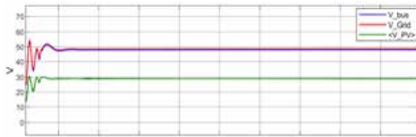
Şekil 12: 250W/m 2 ve 0,5 yük durumunda sistem gerilimleri
