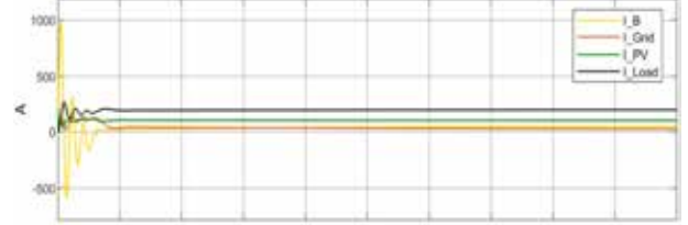
Şekil 22: 500W/m 2 ve tam yük durumunda sistem akımları
