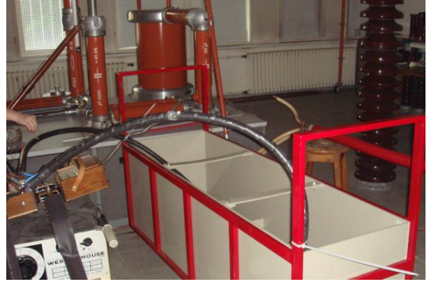
Şekil 2: 0,6/1 kV kablo için kurulan deney düzeneği
