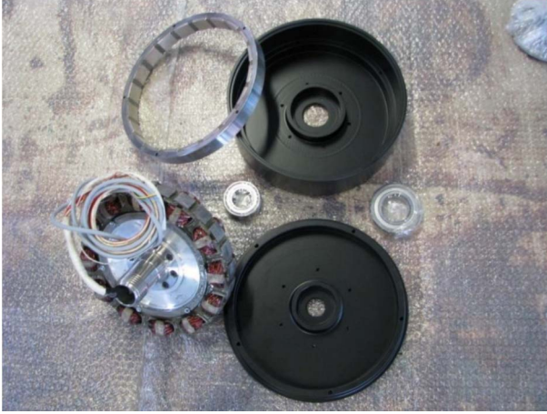
řekil 6: 24-oluk/20-kutuplu tekerlek ii FDA motoru imalat resmi
