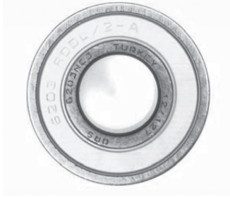
Şekil 3(b): 6203NC3 Tipi Sorunsuz Rulman Örneği
