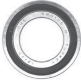
Şekil 3(a): 680106 Tipi Sorunsuz Rulman Örneği
