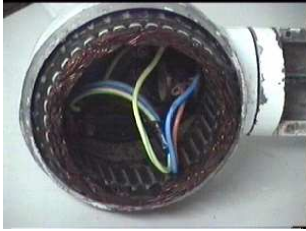
Şekil 3. Dört farklı gerilim elde edilebilecek şekilde sargı uçları makinanın dışına çıkarılmış, 36 oluklu senkron generatör statoru.
