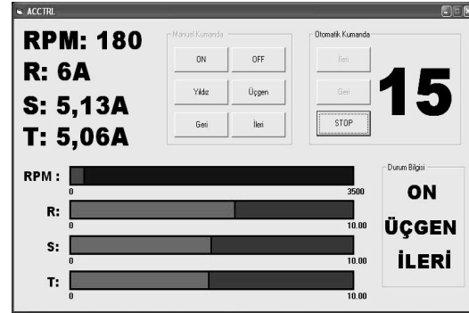
Şekil-5. Visual Basic programlama dili ile yazılmış asenkron motor kontrol ve izleme programı
