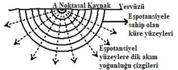
Şekil 2: Akım yoğunluğunun homojen bir toprakta dağılımı [20]
