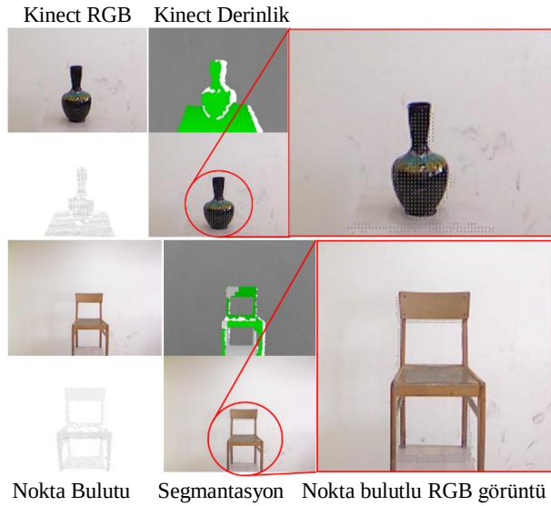
Şekil 1: Nesnelerin nokta bulutu verilerinin RGB görüntüler üzerine aktarım işlemi.
