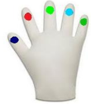
Şekil 2: Parmak Uçlarına Yapıştırılan Renkli Bantların Yerleşimi ve Parmaklara Karşılık Gelen Bitler
