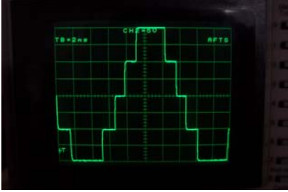
Şekil-12. Çıkış geriliminin deneysel olarak elde edilen görüntüsü (Osiloskop CH2:5x10=50 volt/div)
