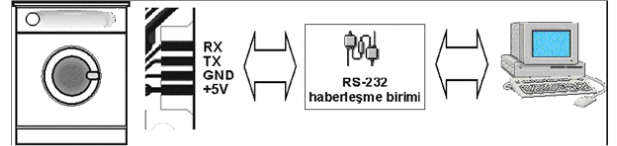
Şekil 2. Çamaşır Makinesi ile dış dünya (PC) haberleşmesi
