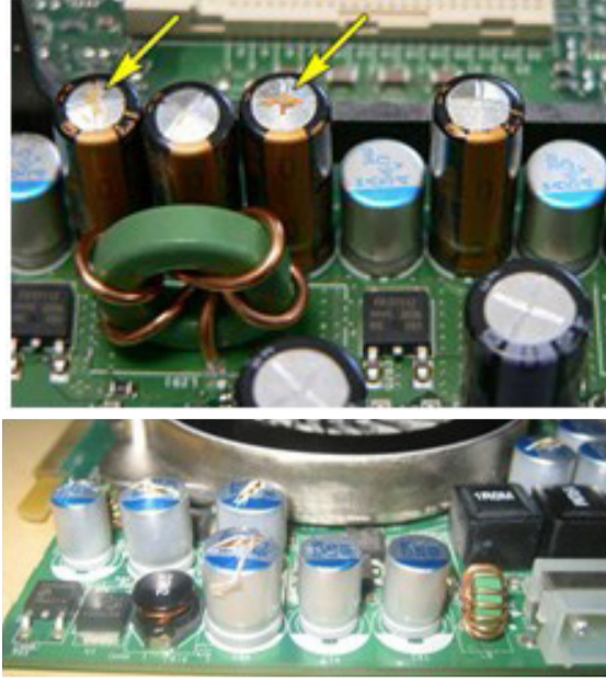
Resim 1.3 Üzerinden çatlamış, şişmiş ve sıvısı akmış kutuplu kondansatörler.
