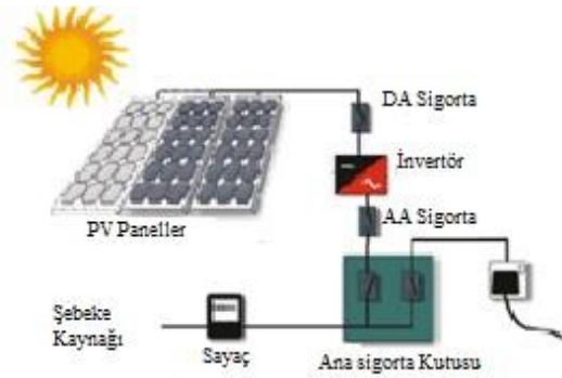
Şekil 5. Şebekeye Bağlı PV sistemi[1]
