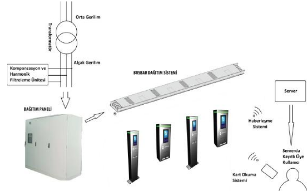
Şekil 8. Elektrikli Araç Şarj İstasyon Sistemi[3]
