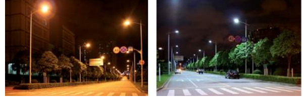
Şekil 1: Sodyum Buharlı Lamba ile LED'li Armatürlerin Renksel Geriverim Değerleri Arasındaki Fark [3]
