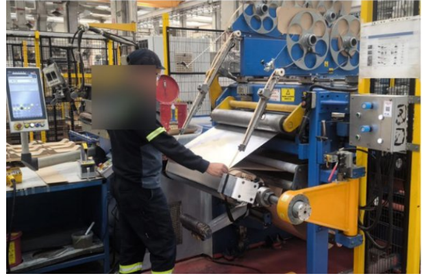
Şekil.1: AG bobin sarım aşaması
