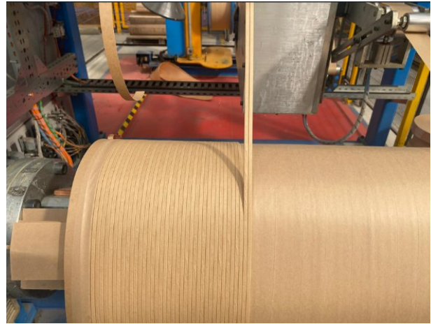
Şekil.2: Yan yana metodu ile YG sarımı
