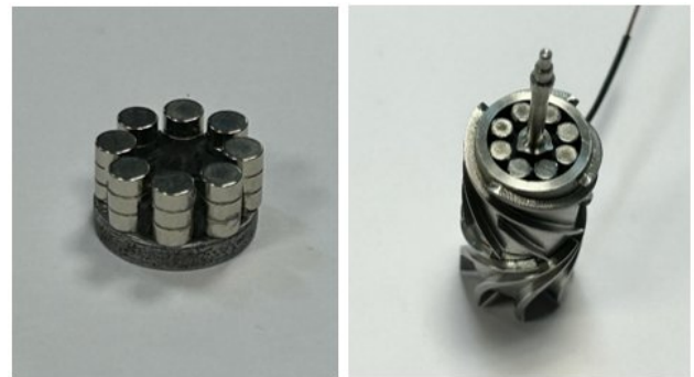
Şekil-5: Rotor kalıcı mıknatıslarının rotor boyunduruđuna (solda) ve motor rotorunun türbin rotoruna yerleştirilmesi (sađda)
