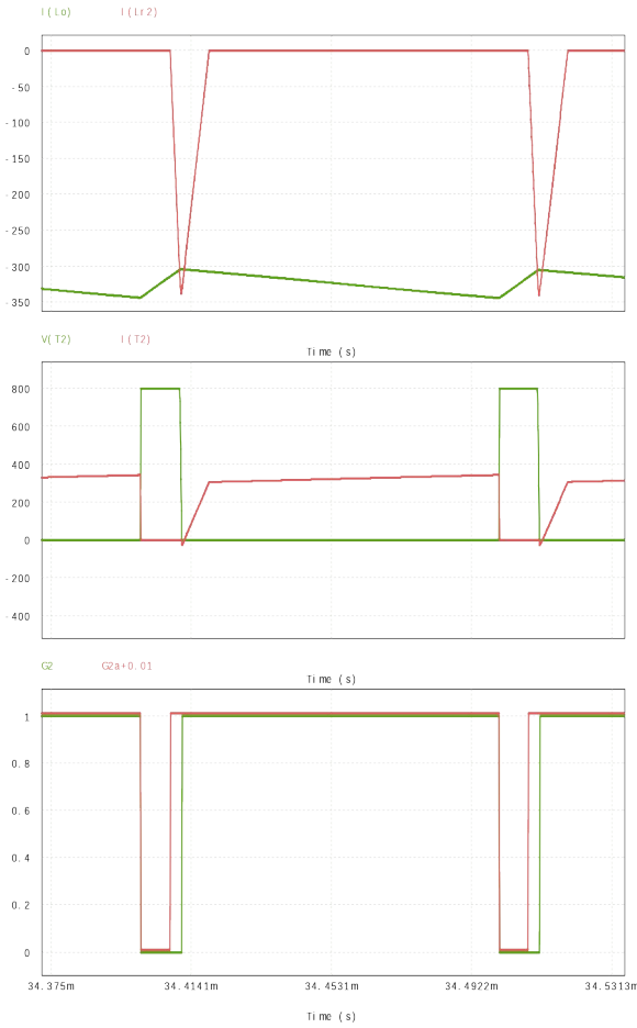
Şekil 11. Negatif alternansta yüksek değerli ana akım ve rezonans endüktans akımları, T_2 anahtarının gerilim ve akım değişimleri ile G_{2a} ve G_2 sürme sinyalleri
