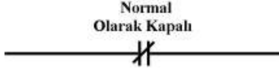
Şekil 1.6 Normal Olarak Kapalı KONTAK için Sembol
